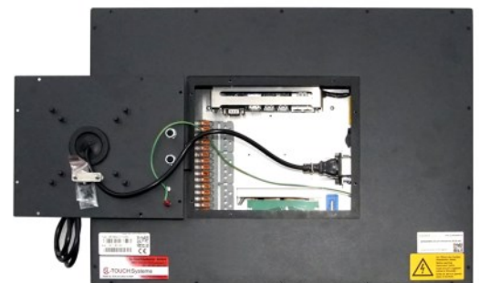
Geöffnete Tragarmklappe - mit Zugentlastung - CPU Stecker und Tastenanschluss - mit integriertem Netzteil
