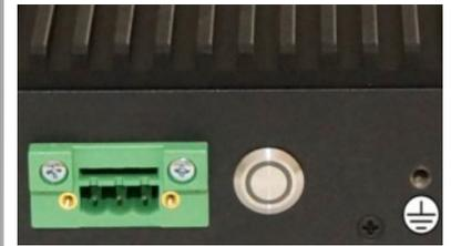
Verschraubter Strom-Stecker sicher gegen verdrehen. Extra Gehäuse - Erdung für Metallgehäuse
