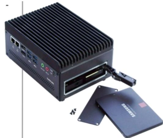
Aufgeschraubter Wechselschacht-Zugriff ein Schacht offen - eine SSD ausgeworfen
