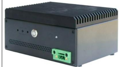
Rückseite mit Stromstecker zum Verschrauben MIT Ausbruch für optionalem COM-Port - Ein-Austaste und zentralem Erdungspunkt
